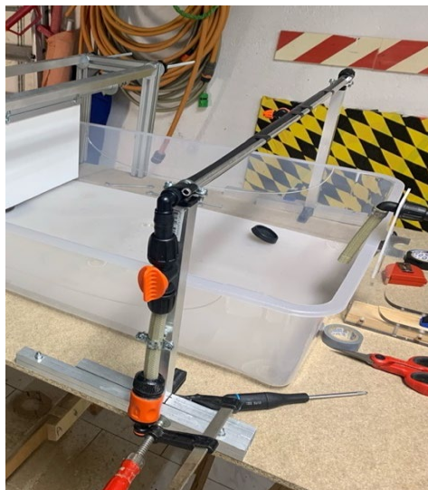
Figura 4: Simulatore fluviale e di precipitazioni meteoriche Fonte: immagine degli autori
