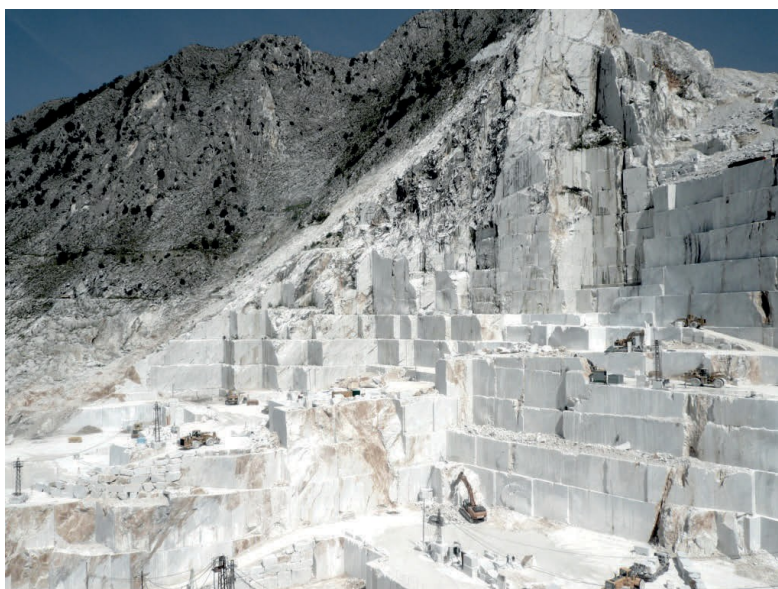
Fig. 1.8 - Le cave di marmo di Carrara, nelle Alpi Apuane, in Toscana, sono state utilizzate fin dall'antichità per il prelievo del materiale lapideo di particolare pregio. Escavazione a gradoni, con macchinari pesanti. Foto degli autori
