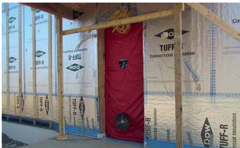
Fig. 5.1 – Porta soffiante in posizione per misurare la perdita d'aria complessiva della struttura con finestre, porte e tutte le altre aperture esterne in posizione (Fonte: National Institute of Standards and Technology, Public domain, via Wikimedia Commons)
