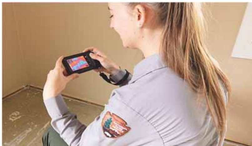
Fig. 5.3 – Documentare i punti deboli dell'involucro termico dell'edificio (Fonte: YellowstoneNPS)
