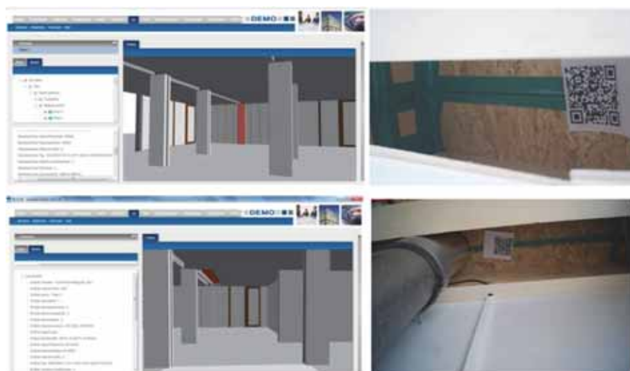
Fig. 7.20 – Confronto tra il modello BIM e il cantiere dove la tenuta stagna della giunzione è stata verificata con il metodo a ultrasuoni e con un controllo visivo mediante rimozione del nastro verde (Copyright 2018, H2020-INSITER Project Consortium Partnership)
