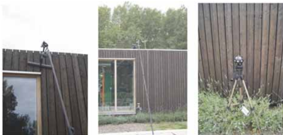
Fig. 7.19 – Il caso studio Green Villages – Sustainer Homes a Delft (Olanda) è stato testato per verificare la qualità di isolamento acustico. Il rumore ambientale è stato misurato all'interno e all'esterno dell'edificio per uffici collocando il trasmettitore sferico insieme al generatore di ultrasuoni vicino ai punti di controllo della tenuta all'aria (Copyright 2018, H2020-INSITER Project Consortium Partnership)
