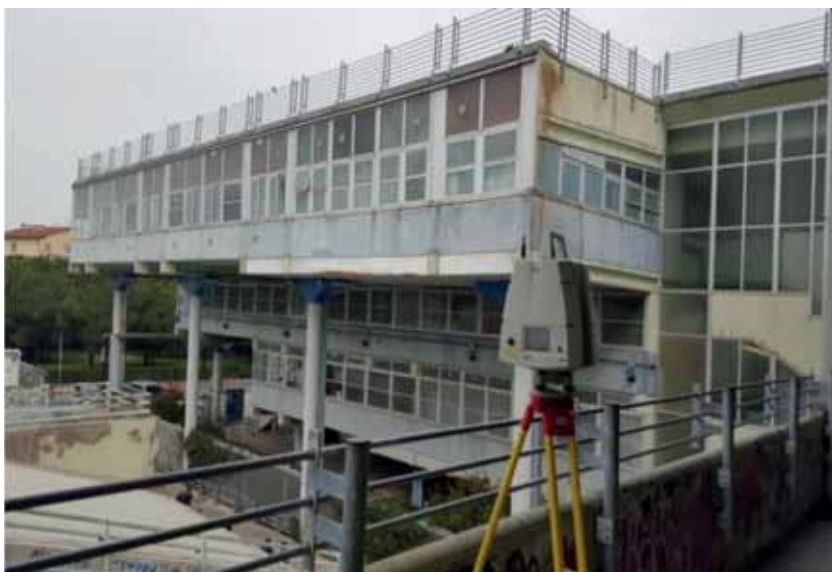
Fig. 7.11 – Fase di rilevamento con tecnologia laser-scanner 3D per ottenere la nuvola di punti e procedere con la modella BIM (Copyright 2018, H2020-INSITER Project Consortium Partnership)
