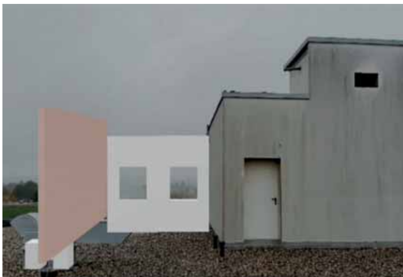
Fig. 7.3 – Simulazione di montaggio, in realtà virtuale, della sopraelevazione del caso studio Health Centre a Colonia in Germania (Copyright 2018, H2020-INSITER Project Consortium Partnership)
