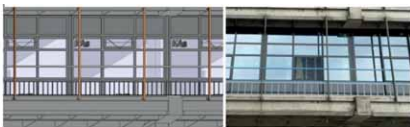
Fig. 7.28 – Comparazione visiva tra il modello BIM (a sinistra) e la situazione reale (a destra) del caso studio Hogeikamp a Enschede (Olanda) (Copyright 2018, H2020-INSITER Project Consortium Partnership)
