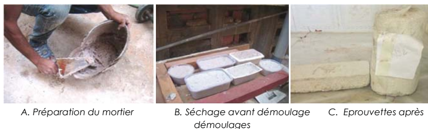
Fig. 02 : Préparation des mortiers de formulation (N.Abderrahim Mahindad)
