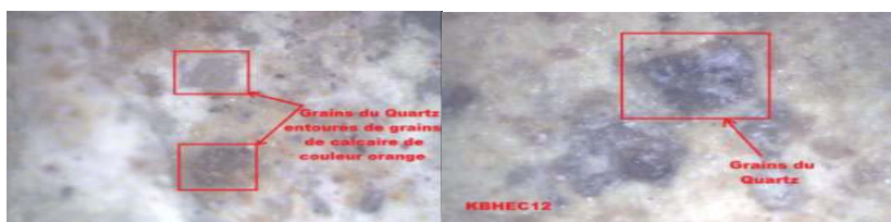
Fig. 05 : Section polie au niveau de la pâte de KBHEC10
