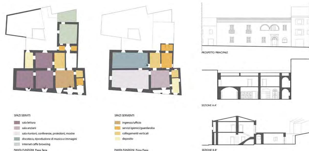
Fig. 3 – Schemi planimetrici di verifica di adattamento delle nuove funzioni, prospetto principale e sezioni
