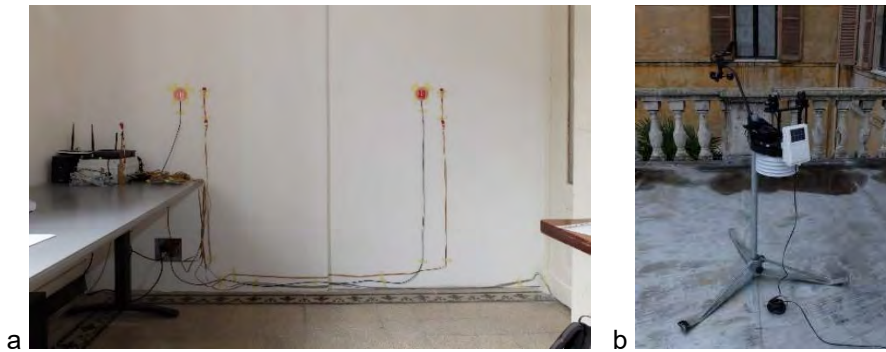
Fig. 4 (a) Termoflussimetri e sonde di temperatura e umidità relativa installati sulla superficie interna delle due pareti isolate termicamente; (b) stazione meteo utilizzata per il monitoraggio delle condizioni climatiche esterne
