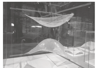
Fig. 3, 4/ Antoni Gaudì. Sistema di catenarie appese ed invertite.
