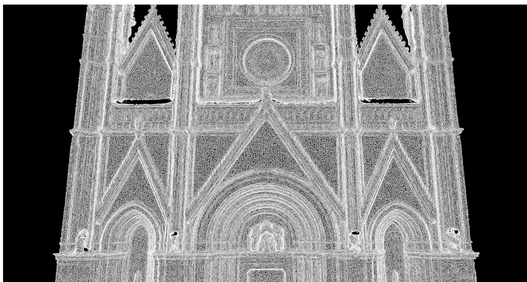
Fig. 4. Mesh poligonale restituita da Metashape.
