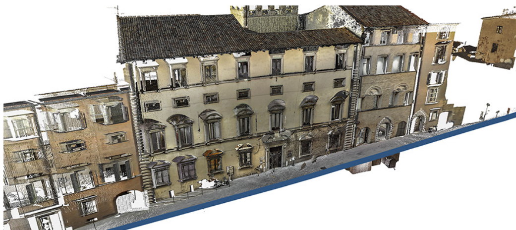
Fig. 4. Risultato dell'integrazione della nuvola di punti derivante dalle scansioni laser con quella delle coperture ottenuta per fotogrammetria aerea mediante drone.
