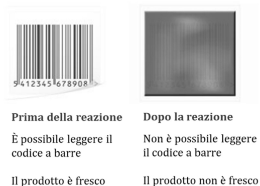
Fig. 3 – Esempio di smart packaging basato su barcode colorimetrico
