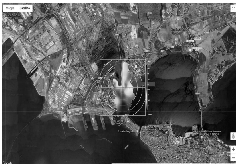
Fig. 4 – Polarplot innestato sulla mappa della città, relativo ai valori di benzene aerodisperso nel periodo gennaio-giugno 2011. Copyright by Google Maps
