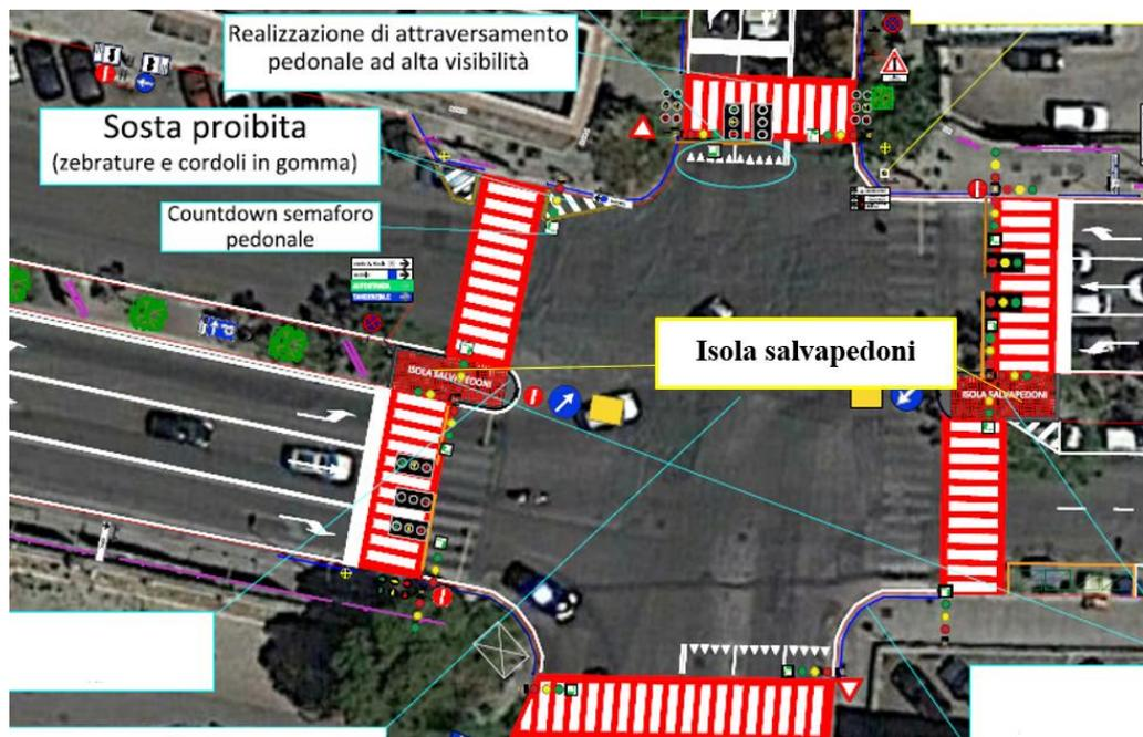
Fig. 14.72: Short-Term countermeasures - Intersection I (Sosta proibita = prohibited parking/realizzazione di rampe per pista ciclabile = construction of cycle path ramps/isola salvapedoni= pedestrian refuge island/Realizzazione di attraversamento pedonale ad alta visibilità = Implementation of high visibility and two-steps pedestrian crossings/Countdown semaforo pedonale = Countdown pedestrian traffic light/zebrature e cordoli in gomma = Zebra patterns and rubber curbs).
