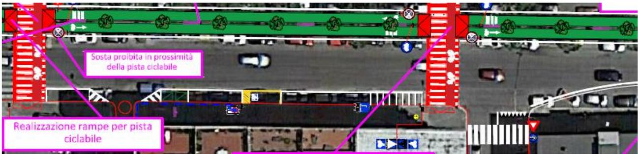
Fig. 14.63: Long-term countermeasures T2 - Southern part” (Sosta proibita in prossimità della pista ciclabile = prohibited parking close to cycle lane/realizzazione di rampe per pista ciclabile = construction of cycle path ramps).
