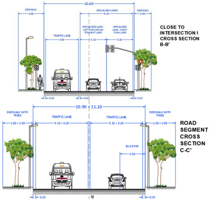
Fig. 14.23: Cross section of Viale Orazio Flacco.
