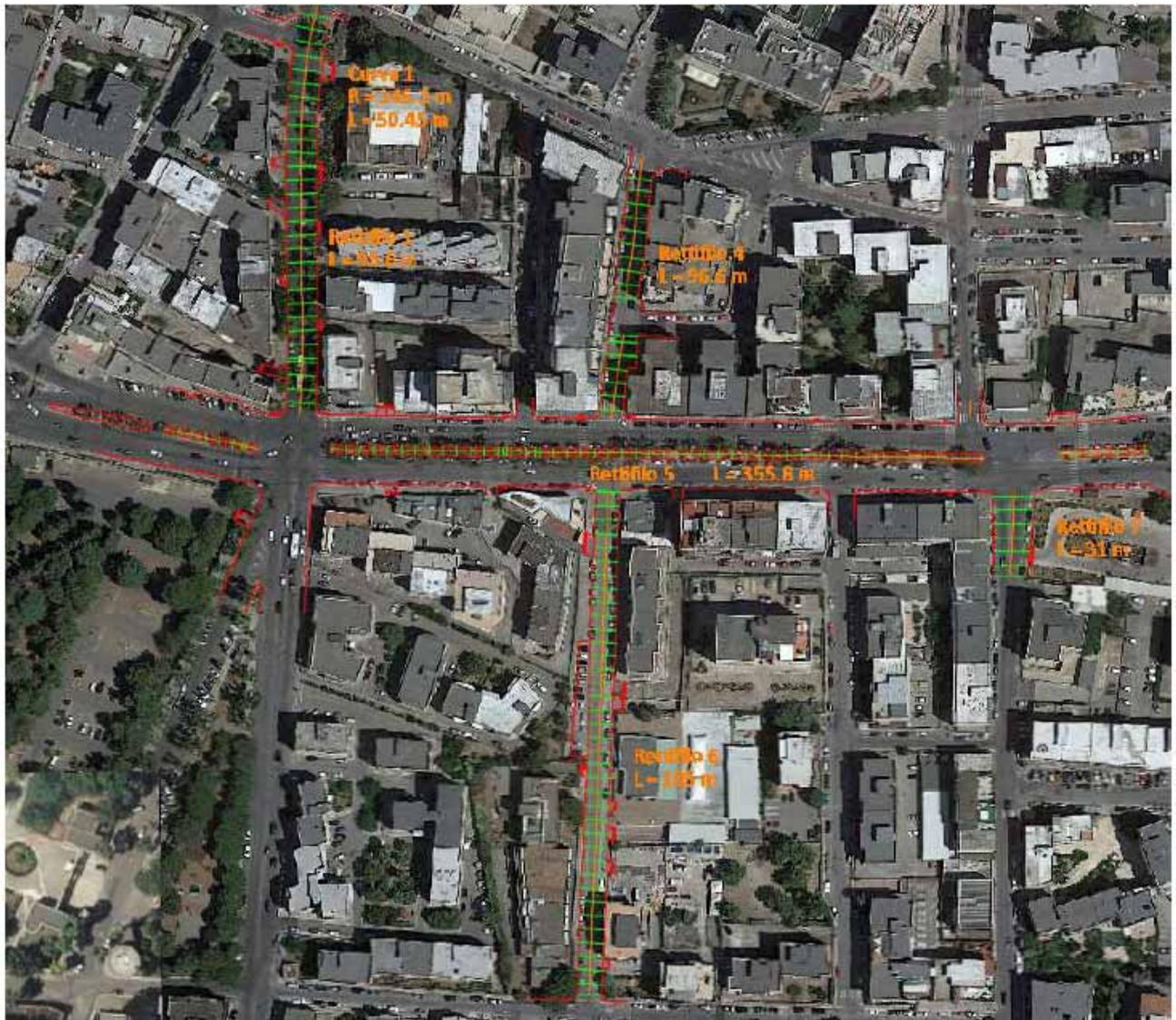
Fig. 6.11: Intera ricostruzione dei cigli e dell'asse stradale per l'area analizzata (fonte della foto: Google Earth).
