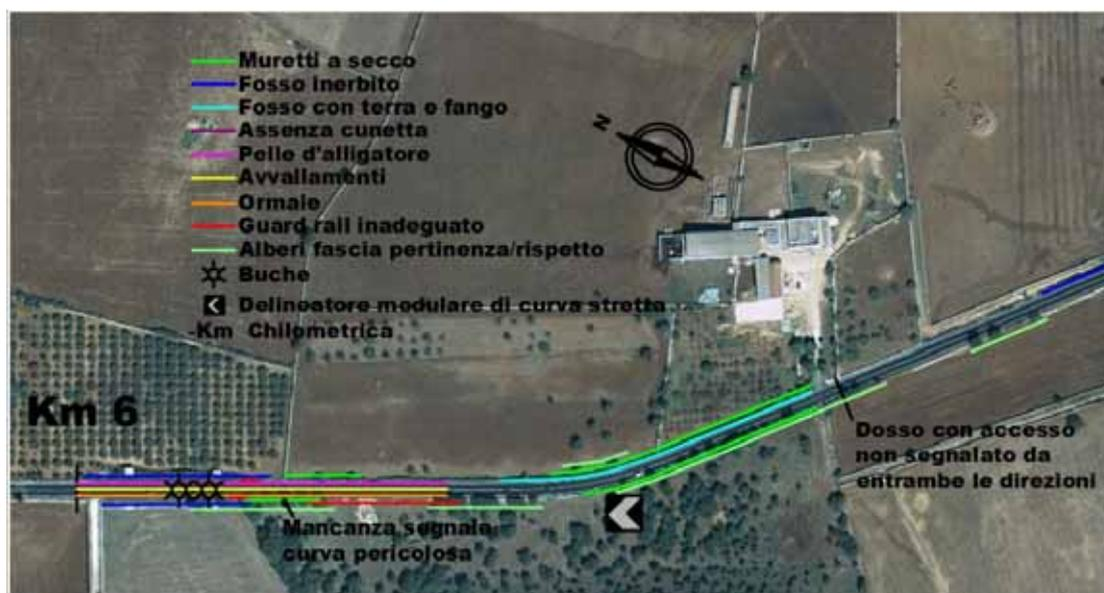
Fig. 5.10: Esempio delle condizioni al contorno - Curva 1 (basato su Colonna et al., 2018<sup>7</sup>).
