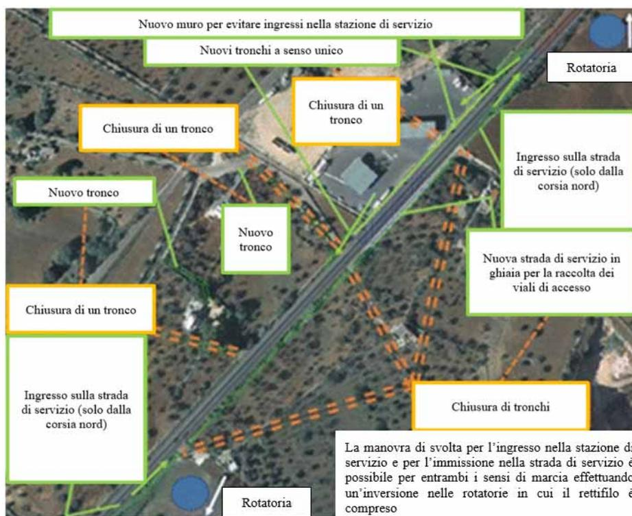
Fig. 5.35: Esempio di strade secondarie per la raccolta di flussi provenienti da intersezioni minori (Colonna et al., 2018<sup>7</sup>).
