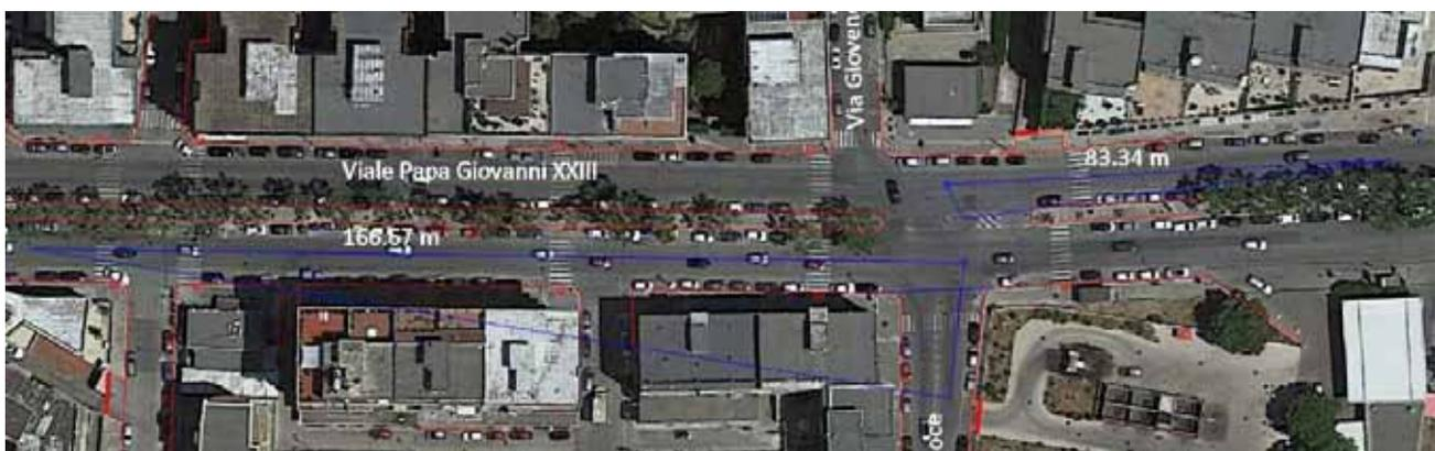
Fig. 6.57: Intersezione IV, triangoli di visibilità (fonte della foto: Google Earth).
