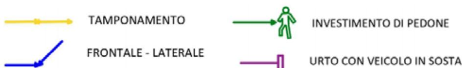
Fig. 6.63: Simboli usati nel diagramma delle collisioni (come suggerito dall'HSM).
