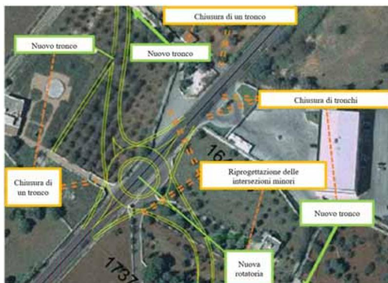
Fig. 5.34: Esempio di rotonda utile a mitigare i problemi derivati da intersezioni con strade minori (Colonna et al., 2018<sup>7</sup>).
