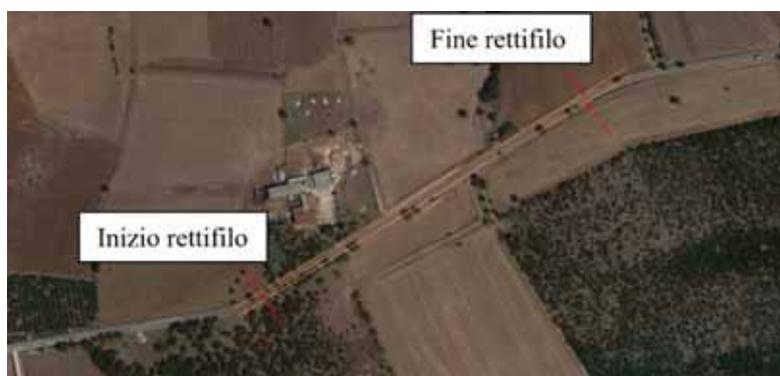
Fig. 5.4: Esempio di ricostruzione dei rettifili.
