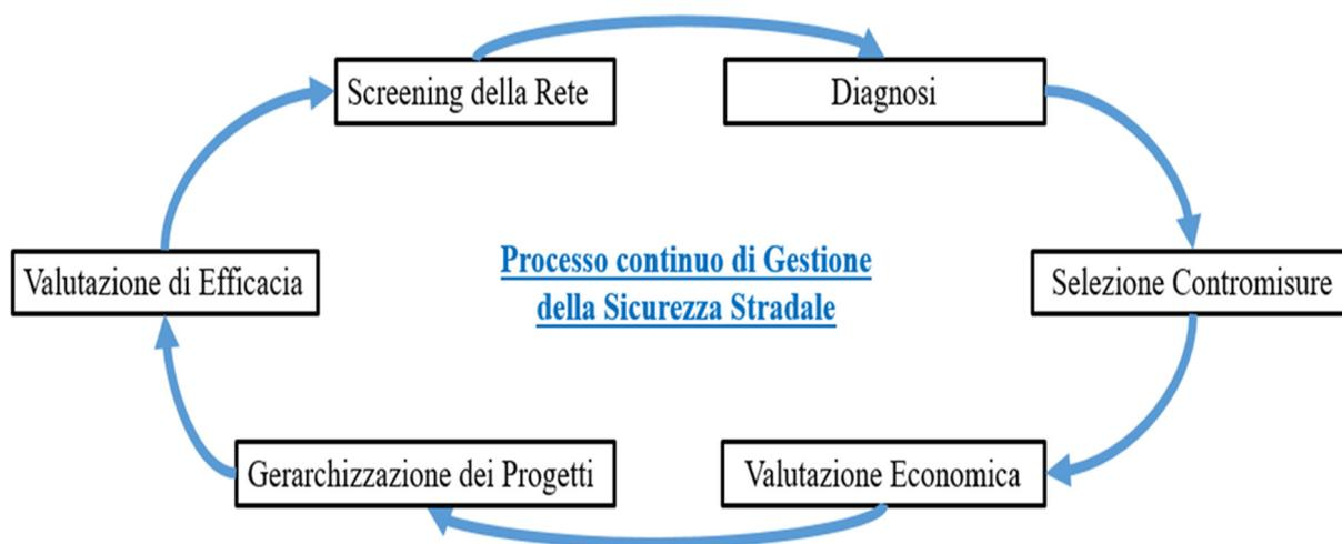
Fig. 2.1: Macro-fasi del processo continuo di gestione della sicurezza stradale (basato su AASHTO, 2010<sup>1</sup>)
