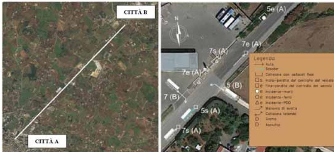
Fig. 5.33: planimetria e diagramma delle collisioni di un esempio di tratto di strada caratterizzato da numerosi accessi e da intersezioni minori (Colonna et al., 2018<sup>7</sup>).
