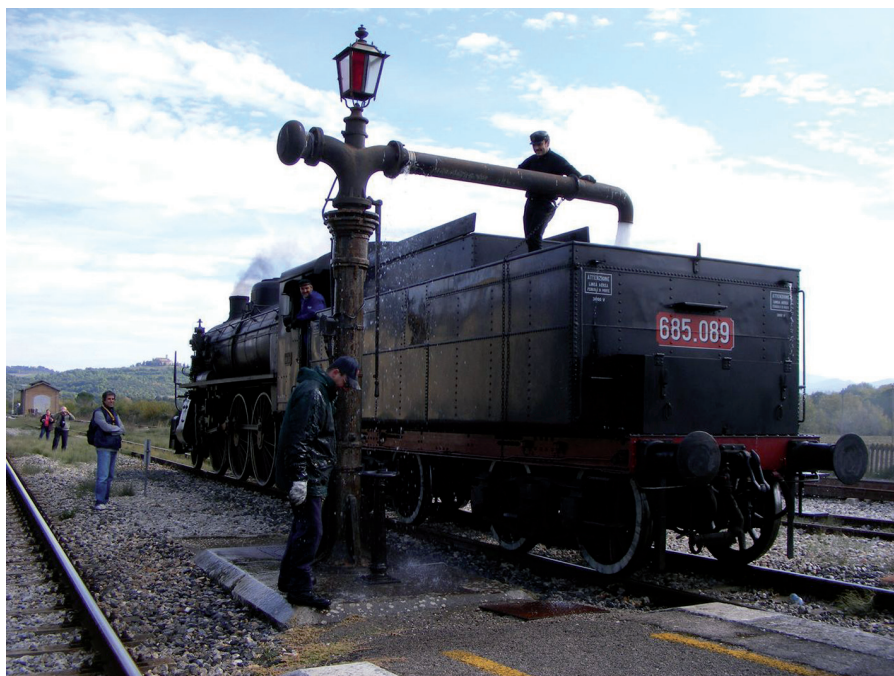
Fig. 4 - Locomotiva 685 a Monte Antico durante il rifornimento acqua. Fonte: foto di Alessandro Giosuè
