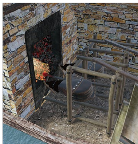
Figura 29. Duplice visione ricostruttiva prospettica del forno fusorio di Vedello e del sistema di alimentazione a doppio mantice.
