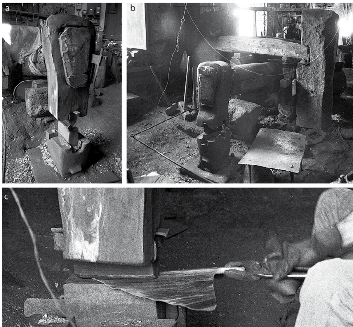
Figura 30. Particolari: a. testa di maglio; b. struttura di un maglio a testa d'asino o d'ariete; c. della sua azione battente in una fucina della Val Camonica nel bresciano (foto Roberto Prediali).
