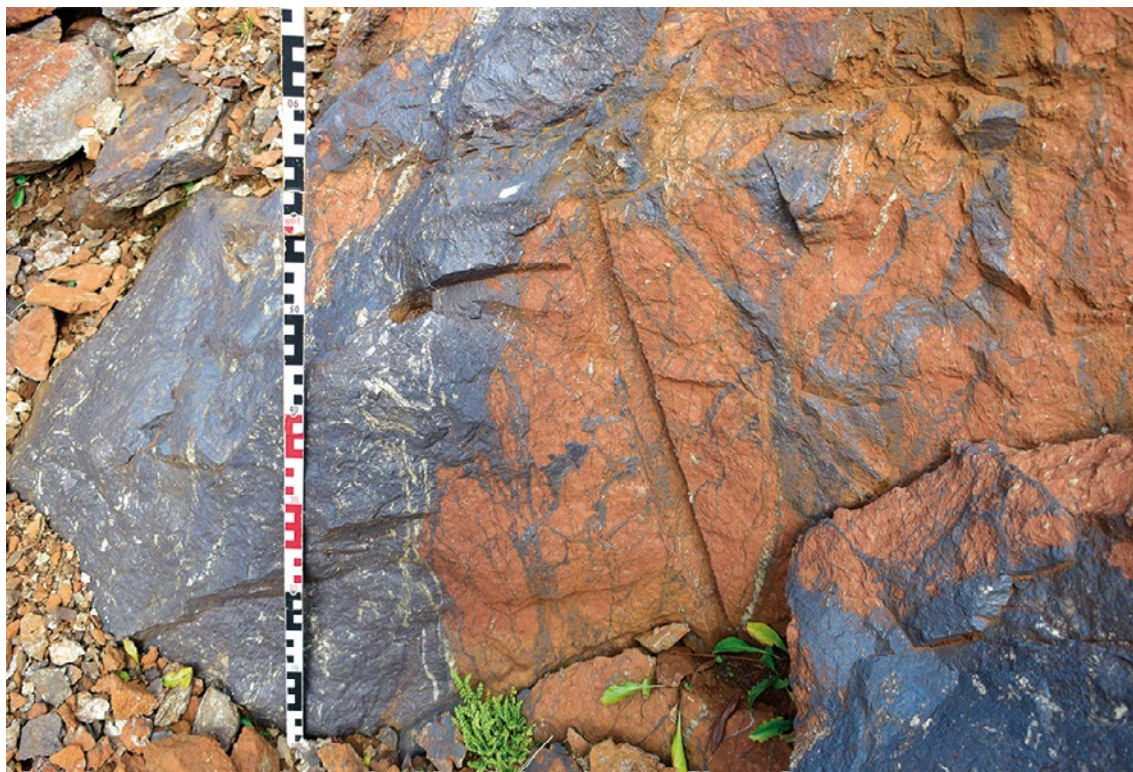
Figura 29. Val Venina (2.165 m), fronte di cava a cielo aperto con foro di mina visibile sulla parete (foto Enrico Croce).
