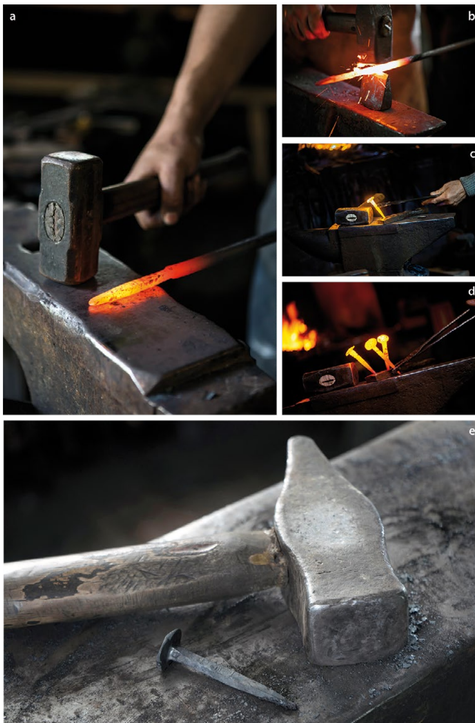
Figura 32. Forgiatura di chiodi in quattro passaggi: a. Asta riscaldata e precedentemente assottigliata sulla quale sono portati colpi leggeri su un tagliolo di incudine per delimitare il punto in cui l'asta verrà spezzata; b. Sul foro rotondo posto sul piano dell'incudine si introduce l'asta nel foro della chiodaia e piegata fino a farla spezzare nel punto precedentemente segnato; c. La testa del chiodo viene ribattuta e modellata sulla chiodaia; d. Tenaglie a punta piatta che consentono di afferrare il chiodo per la sua estremità inferiore e modellarlo a colpi di martello; e. Un chiodo al termine della fase produttiva (foto Paolo de Vingo).
