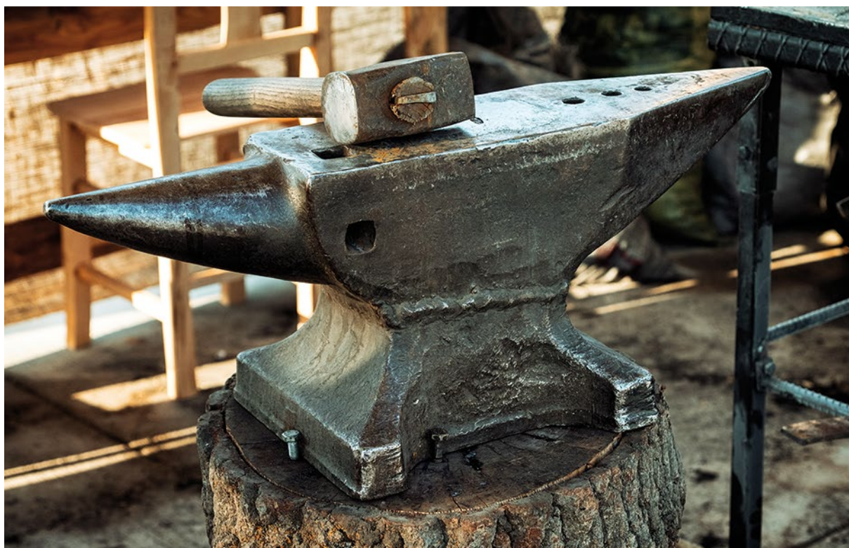
Figura 31. Incudine bicornia con un martello, lo strumento più caratteristico dell'attività del fabbro (foto Paolo de Vingo).
