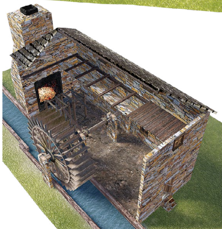
Figura 29. Duplice visione ricostruttiva prospettica del forno fusorio di Vedello e del sistema di alimentazione a doppio mantice.
