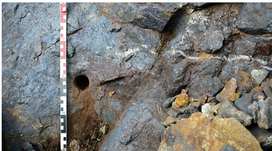
Figura 30. Val Venina (2.165 m), fronte di cava a cielo aperto con foro di mina in corso di preparazione (foto Enrico Croce).
