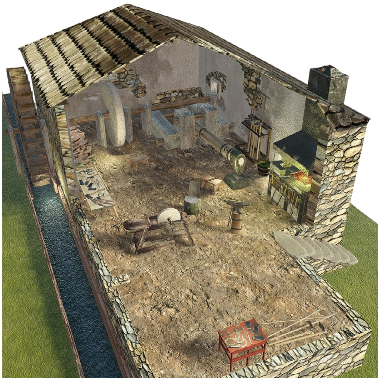
Figura 34. Ricostruzione dello spazio interno della fucina con la presenza di due mole, la prima manuale e la seconda ad azionamento meccanico.
