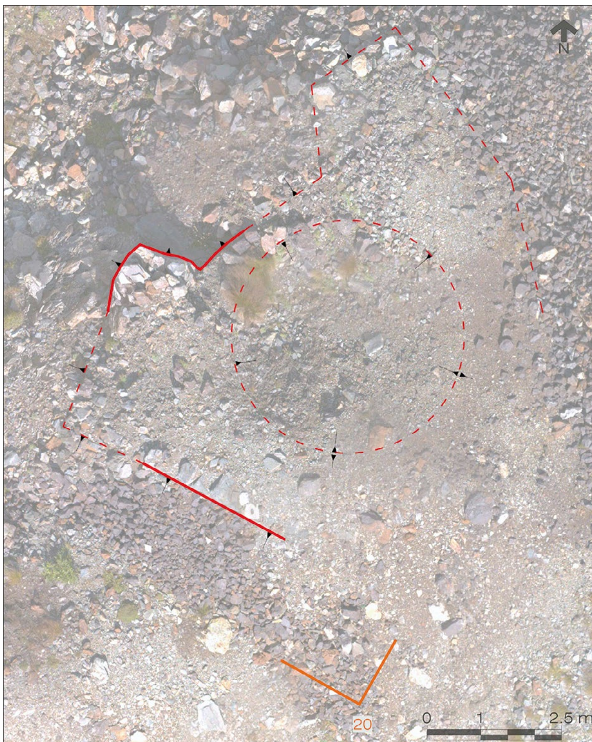
Figura 21. Piateda. Complesso minerario di Venina. Rilievo dei resti ancora in luce pertinenti il secondo forno di arrostitimento.
