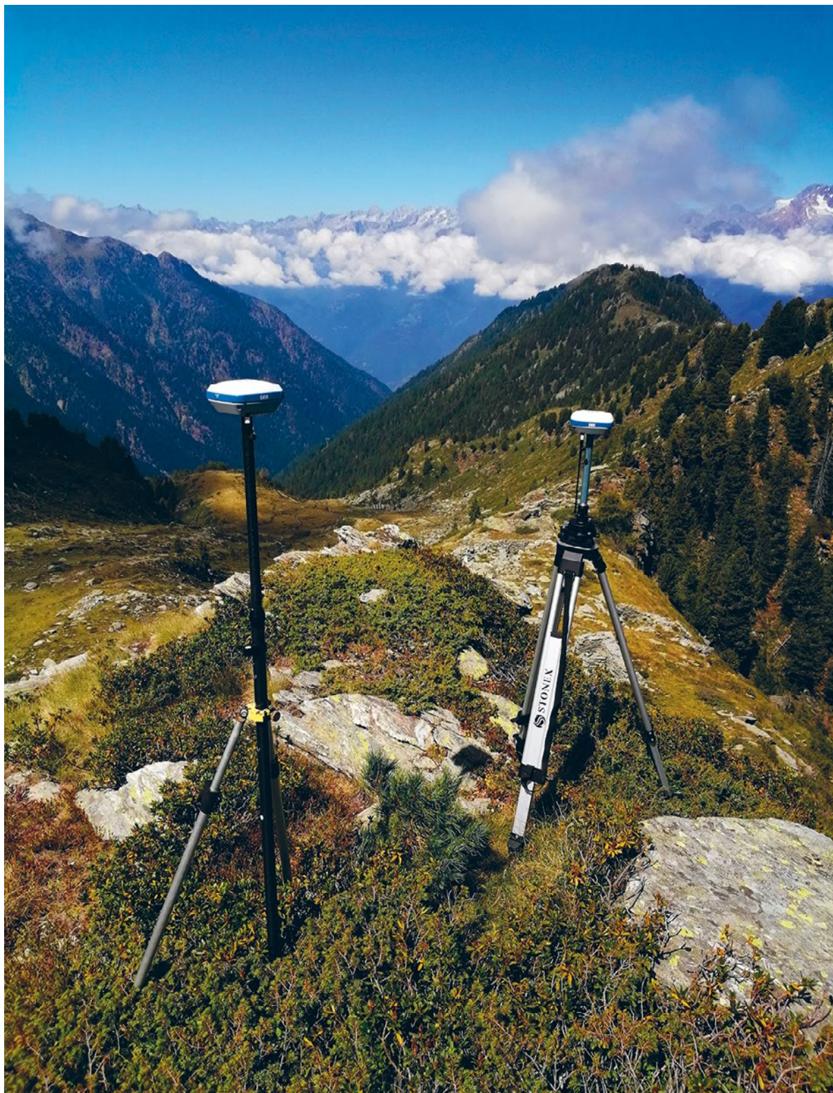
Figura 1. I due ricevitori dello strumento GPS, denominati Base e Rover, durante il rilievo delle baite dei minatori a Fusine (foto Paolo Bertero).
