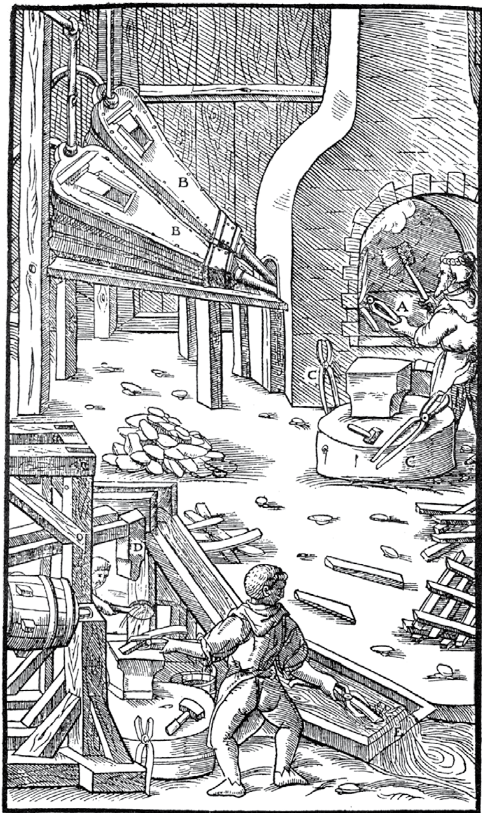
Figura 19. Agricola, De re metallica , libro IX, p. 36, maglio laterale e coppia di mantici.
