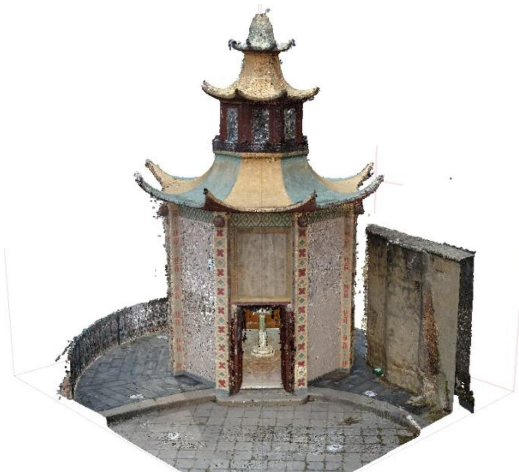
Fig. 03. Nuvola di punti ottenuta dal rilievo fotogrammetrico aereo della pagoda in villa Doria d'Angri. Rilievo e processamento di Simona Scandurra.
