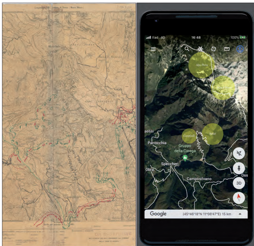
Fig. 1 - A sinistra: dettaglio della [Carta al 25.000 con le difese italiane e austriache aggiornata all'agosto 1916] del territorio tra la Vallarsa e il Monte Zugna (Fonte: Archivio del Museo Storico Italiano della Guerra, Fondo cartografico, 7.43); a destra: evidenziazione dei trinceramenti e dei toponimi in file KML (Fonte: elaborazione di Giannantonio Scaglione)
