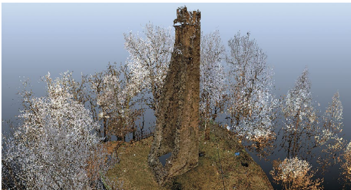
Figura 1. La torre del Castello dell'Acqua visto attraverso l'occhio elettronico del 3D Laser Scanning.
