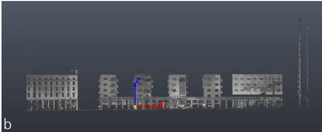
Fig. 3/ a-b) Viste ortografiche superiore e frontale della nuvola di punti con l'indicazione della terna di assi di riferimento. c) Immagine panoramica catturata dallo scanner. Gli assi del sistema di riferimento cartesiano sono stati rappresentati secondo la codifica RGB (Red, Green, Blue) utilizzata dai software di modellazione e rendering: rosso per l'asse x, verde per l'asse y e blu per l'asse z.
