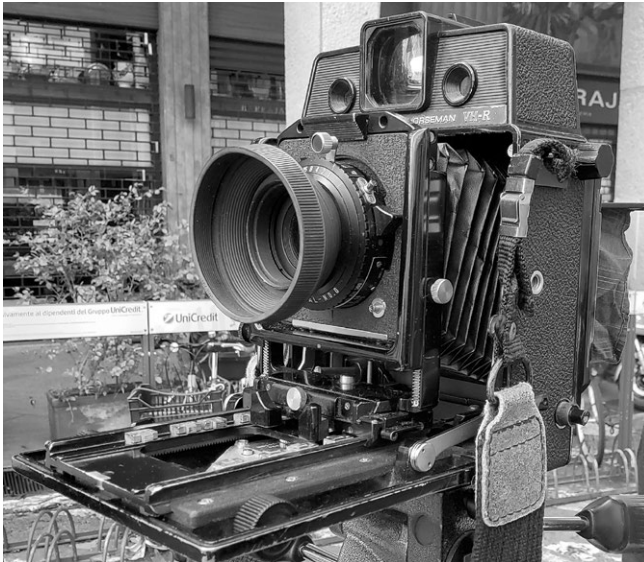
Fig. 6)/ Banco ottico in posizione prima dell'acquisizione della foto utilizzata più avanti. Si noti il decentramento verso l'alto della standarta anteriore.
