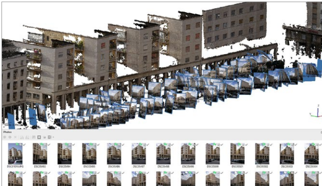
Fig. 4/ Rilievo fotogrammetrico della corte; dalle immagini orientate, rappresentate da piccole superfici rettangolari densamente accostate, è stata generata una nuova nuvola di punti degli edifici che delimitano la piazza.
