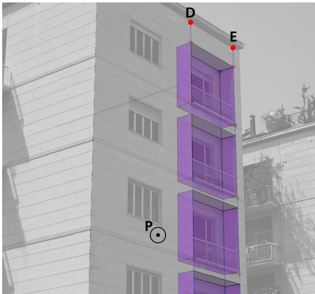
Fig. 8/ a) Modello digitale della loggia, realizzato in una vista generica dello spazio virtuale. b) Verifica della congruenza proiettiva fra immagine e modello in vista vincolata.
