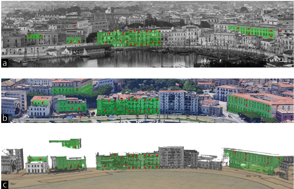
Fig. 72/ Il fronte della Cala. In verde gli edifici sopravvissuti ai bombardamenti e rimasti in situ ; in rosso i punti utilizzati per il calcolo dell'orientamento dell'immagine. a) Foto Bronzetti del 1930. b) Immagine dello stato di fatto tratta da Google Earth . c) Nuvola di punti acquisita con laser scanner.
