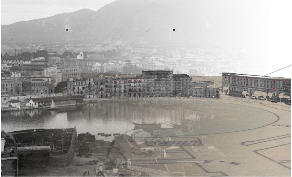
Fig. 74/ Sovrapposizione con sfumatura della fotografia e della vista vincolata dal centro di proiezione V della nuvola di punti per la verifica visiva della corrispondenza.
