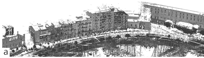
Fig. 71/ a) Rilievo con laser scanner del fronte della Cala. b) Posizionamento della nuvola di punti sulla carta O.M.I.R.A. del 1935.
